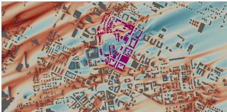
Campo medio di temperatura: escursione di 5 [°C] rispetto alla temperatura indisturbata dell'ambiente, fortemente anticorrelata rispetto al campo di velocità, temperatura più bassa dove il modulo di velocità è maggiore.
